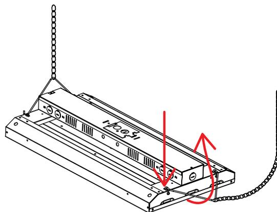
3. Fixer la chaîne au point d'installation.
