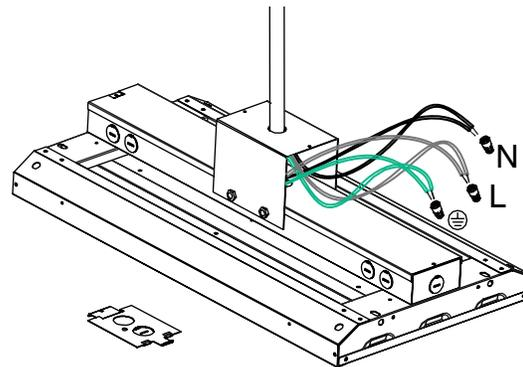
5. Protéger le bloc de jonction en vissant les plaques d'accès sur le support de suspension.
