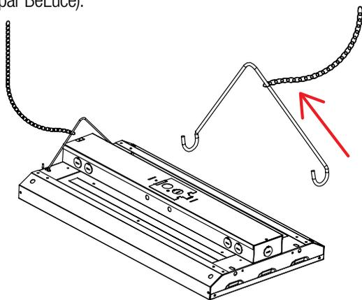
2. Insérer l'agrafe en V dans le trou, tourner le crochet vers le haut.
