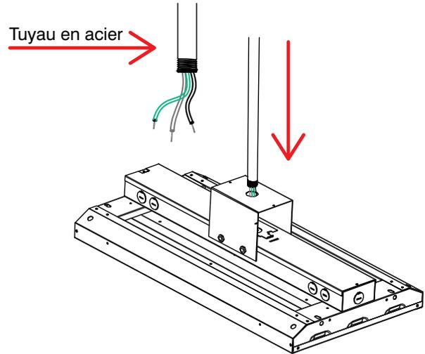
3. Fixer la tige au support à l'aide de l'écrou de blocage.
