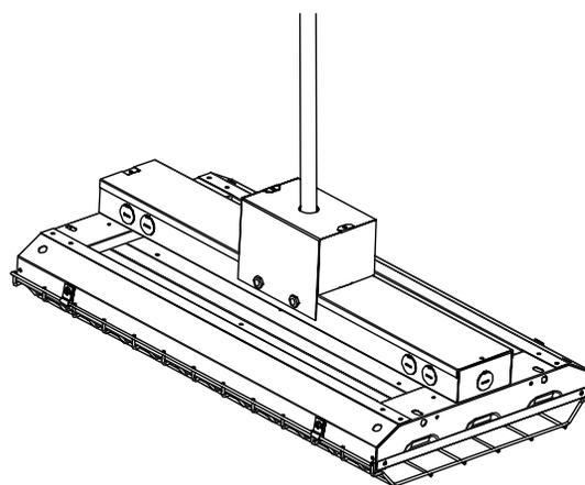
5. Convient également au montage sur **chaîne** ou au **montage sur câble d'aéronef**.
