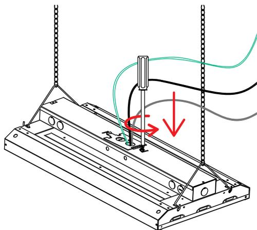
8. Ajuster la hauteur du luminaire, mettre de niveau et équilibrer.
