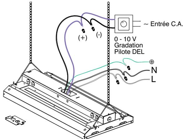
7. Acheminer le câblage par un conduit souple (non fourni par BeLuce). Visser le couvercle en place sur l'unité.
