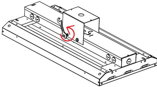
2. Insérer la tige dans le support de suspension par le trou fileté.
