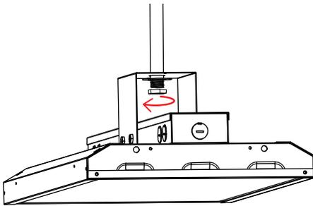
4. Connecter l'alimentation C.A. et la mise à la terre tel qu'indiqué sur les conducteurs fournis. Isoler tout fil non utilisé !
