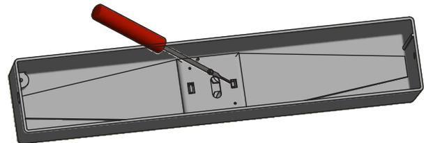
4. Pour installer une nouvelle lentille, insérer d'abord le plus gros crochet dans l'un des côtés de la carte DEL, puis glisser délicatement et pousser vers le bas la lentille vers le côté opposé, jusqu'à ce qu'elle s'enclenche dans la plus petite fente d'un clic.
