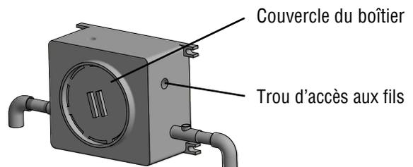
5. Effectuer le raccordement; se reporter au schéma de câblage (figure 3). **Le câblage des unités avec options supplémentaires peut varier; lire les étiquettes fournies.**
