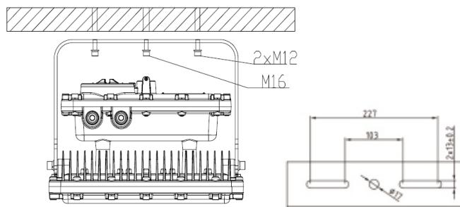
Percez trois trous dans le mur pour fixer le luminaire : un trou destiné à recevoir des ancrages mécaniques M16 (non fourni) et deux trous destinés à recevoir des ancrages mécaniques M12 (non fournis). Les diamètres des trous sur le support du luminaire sont de 17 mm pour un trou et de 13 mm pour les deux autres.
