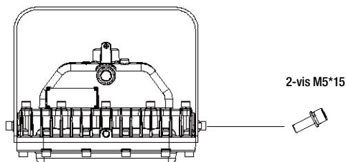
Sortez le luminaire et les accessoires de la boîte en carton, puis serrez les 2 vis à tête cylindrique à six pans creux.
