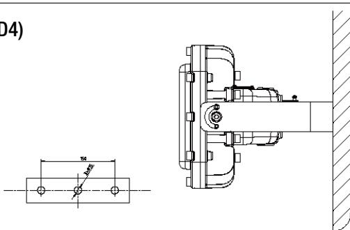
Percez trois trous destinés à recevoir des ancrages mécaniques M12 (non fournis) dans le mur pour fixer le luminaire. Le diamètre des trous sur le support du luminaire est de 15 mm et l'espacement est de 150 mm.
