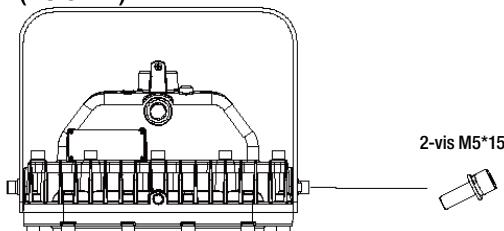
Sortez le luminaire et les accessoires de la boîte en carton, puis serrez les 2 vis à tête cylindrique à six pans creux
