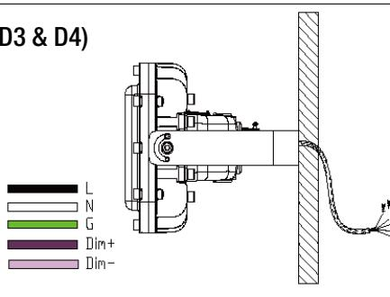
Raccorder le câble AC à l'alimentation : noir à L, blanc à N, vert à G (mise à la terre), violet à Dim +, rose à Dim -.
