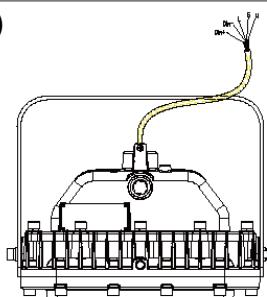
Installez les conduits métalliques flexibles et serrez-les.
