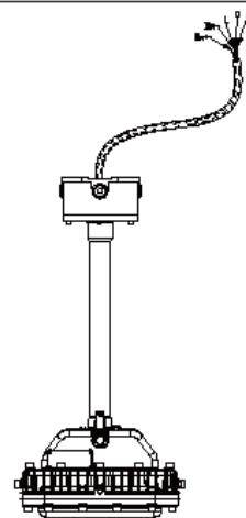
Une extrémité est fixée à un endroit pouvant supporter au moins 30 kg de force, comme une poutre en acier, un mur, etc.
