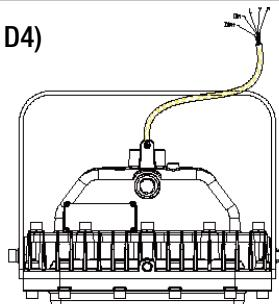
Installez les conduits métalliques flexibles et serrez-les.
