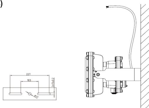
Percez trois trous dans le mur pour fixer le luminaire : un trou destiné à recevoir des ancrages mécaniques M16 (non fourni) et deux trous destinés à recevoir des ancrages mécaniques M12 (non fournis). Les diamètres des trous sur le support du luminaire sont de 17 mm pour un trou et de 13 mm pour les deux autres. L'espacement minimum est de 103 mm et l'espacement maximum est de 227 mm.
