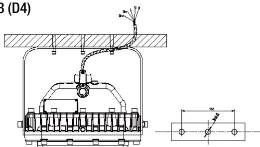
Percez trois trous destinés à recevoir des ancrages mécaniques M12 (non fournis) dans le mur pour fixer le luminaire. Le diamètre des trous sur le support du luminaire est de 15 mm et l'espacement est de 150 mm.
