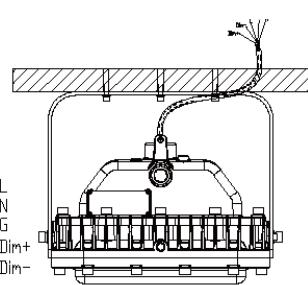
Raccorder le câble AC à l'alimentation : noir à L, blanc à N, vert à G (mise à la terre), violet à Dim +, rose à Dim -.
