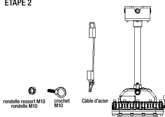
Lors du serrage du câble d'acier, une extrémité est fixée sur le crochet M10 installé sur le boîtier du luminaire, et l'autre extrémité est fixée à un endroit pouvant supporter au moins 30 kg de force, comme une poutre en acier, un mur, etc.
