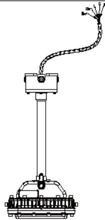
Raccorder le câble AC à l'alimentation : noir à L, blanc à N, vert à G (mise à la terre), violet à Dim +, rose à Dim -.
