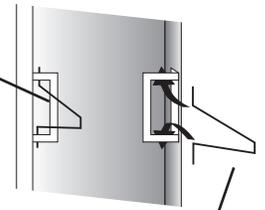
Insérer/enlever un côté de l'agrafe sous la languette, puis insérer/enlever l'autre côté
