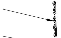
2. Accrocher la chaîne et le boulon ensemble à l'aide du crochet en « S » fourni.
