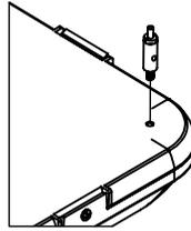
2. Passer le câble à travers le coulisseau de réglage (se servir des coulisseaux de réglage pour mettre le luminaire de niveau). (Appuyer sur le dessus de la gaine du coulisseau pour dégager le blocage et ajuster le câble.)
