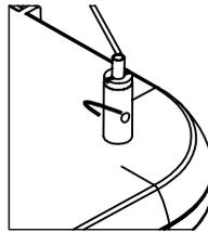
3. Ajuster la hauteur du luminaire à l'aide de ce coulisseau de réglage (se servir des coulisseaux de réglage pour mettre le luminaire de niveau). (Appuyer sur le dessus de la gaine du coulisseau pour dégager le blocage et ajuster le câble.)
