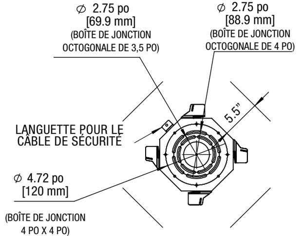
**ASTUCE :** Pour faciliter l'engagement du luminaire sur le support de montage, on recommande de tracer des lignes temporaires parallèles aux rives droites du support (comme illustré ci-dessus), utiliser ces lignes pour aligner votre luminaire avant de le tourner pour bloquer le luminaire sur le support.
