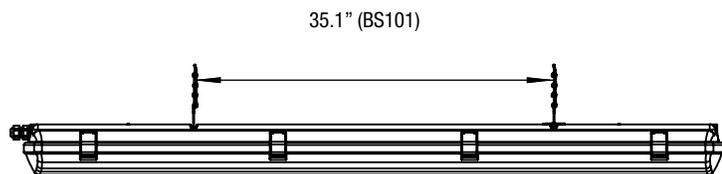
1. Insérer le crochet dans les trous sur le dessus du support de montage au-dessus du boîtier, comme illustré.
