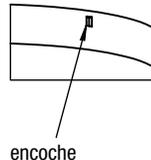
**NOTE:** Tourner le pavillon pour que la languette s'engage dans l'encoche sur le pavillon.
