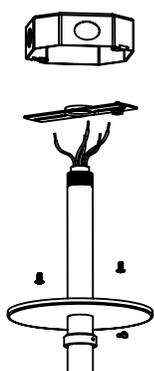
Montage du pavillon (monture pivotante)
