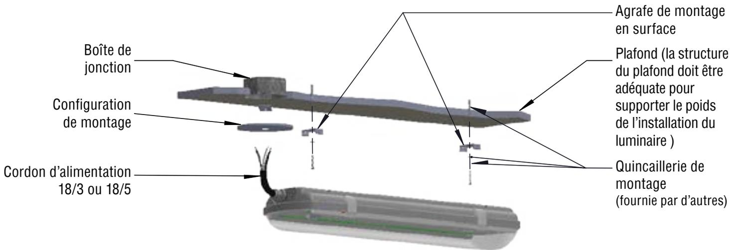
Les fils de gradation 0 - 10 V doivent être acheminés par un conduit séparé depuis la boîte de jonction.
