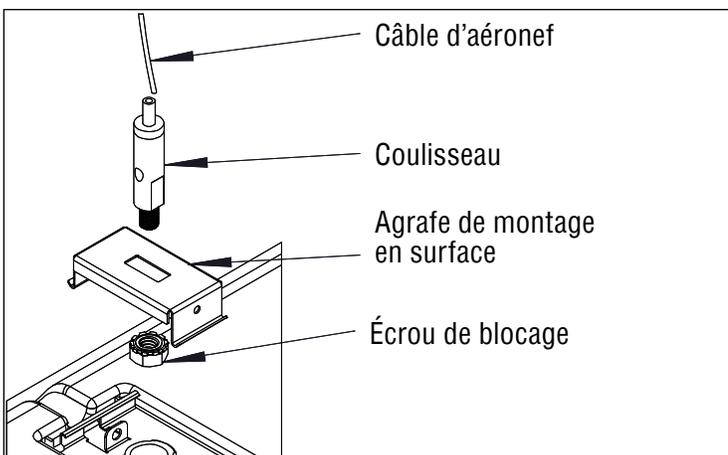
1. Fixer le coulisseau du câble à l'agrafe de montage en surface à l'aide de l'écrou de blocage fourni comme illustré.
