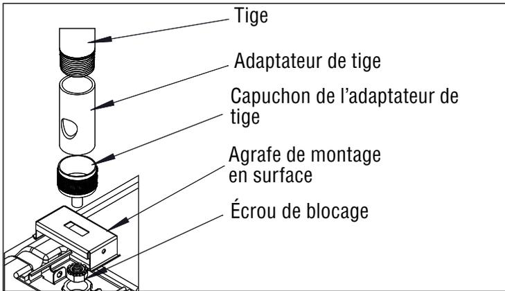
1. Fixer le capuchon de l'adaptateur de tige à l'agrafe de montage en surface à l'aide de l'écrou de blocage fourni comme illustré.
