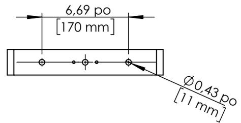
2. Utiliser les boulons d'ancrage types similaires à ceux recommandés en taille et longueur. Installer les boulons d'ancrage conformément à la directive d'installation relative aux boulons.
