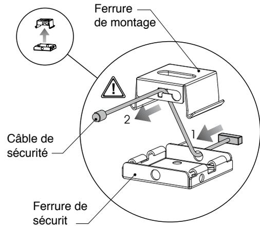
3. Installer le luminaire en encliquetant la ferrure de montage dans la ferrure de sécurité.
